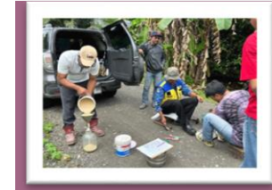
Pengujian Kepadatan Tanah dengan Sand Cone
