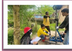
Pengujian untuk Memperoleh Data Tanah Sesuai Dengan Kedalamnya (Sondir Ringan)
